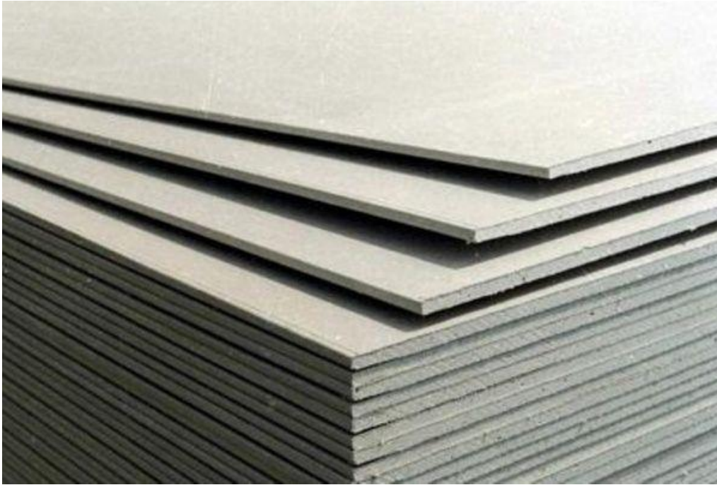
Ilustración 4-a (planchas de fibrocemento)
