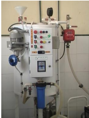
Fotografía 3 y 4 Central de Biodiesel con una capacidad de 1 \times 10^{-3} \text{ m}^3\text{-día}
