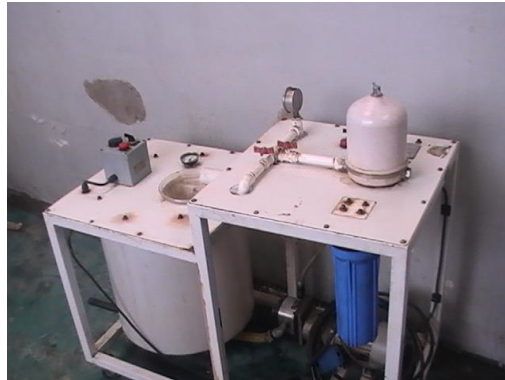
Fotografía 3 y 4 Central de Biodiesel con una capacidad de 1 \times 10^{-3} \text{ m}^3\text{-día}
